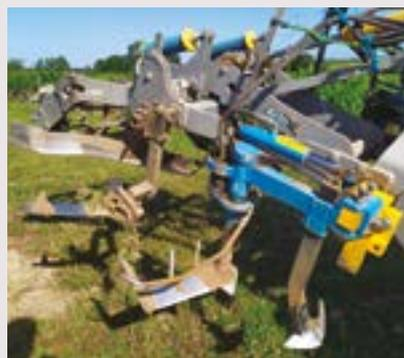
Monté sur chassis inter-rangs : lames bineuses avec versoir jumelées avec des lames folles
