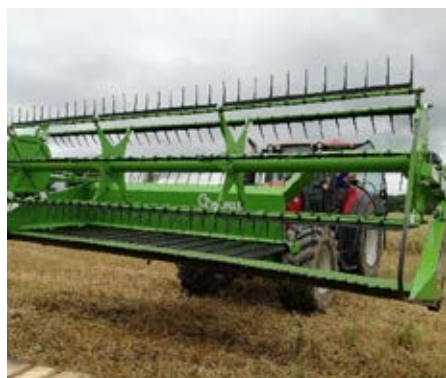
Faucheuse-andaineuse ZWORLD 5 mètres Attelée à l'avant d'un tracteur 175 cv (puissance supérieure aux besoins de l'outil)
